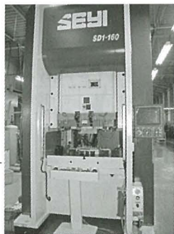
上／新たに導入した台湾 SEYI 製 160t サーボプレス 右／ベテラン職人が支える金型部門
