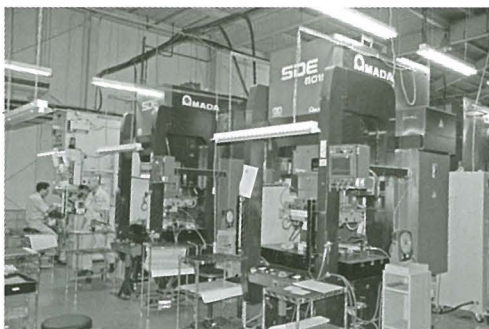
左/サーフ工法を実現するサーボプレス 右/プリント基板のルーター加工も手掛ける
